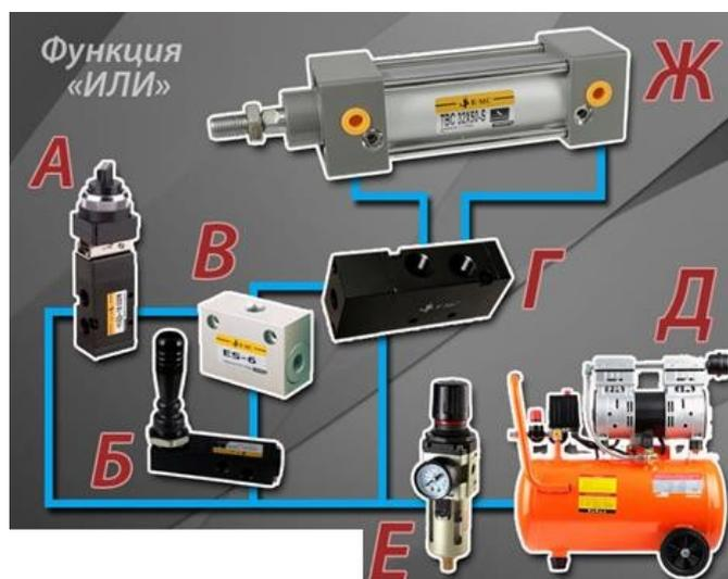
Если при сборке данной пневмосистемы входные каналы распределителя объединить через пневмофитинг-тройник, то воздух одного из двух распределителей будет выходить через выпускной канал другого распределителя. Во избежание этой проблемы нужно использовать перекидной логический клапан «ИЛИ» ES-8 (на рис."В").
