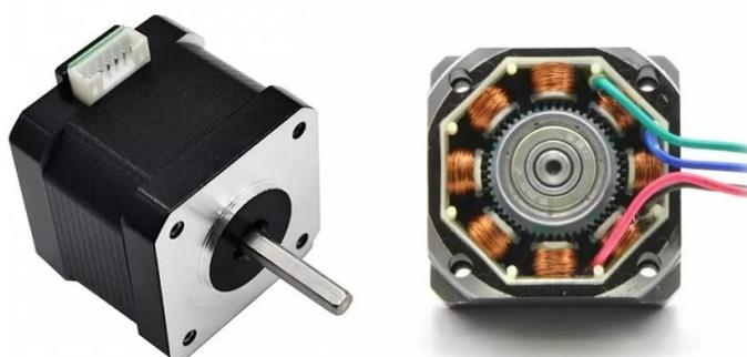
**Шаговый электродвигатель** — это синхронный бесщёточный электродвигатель с несколькими обмотками. Ток, подаваемый в одну из обмоток статора, вызывает фиксацию ротора. Последовательная активация обмоток двигателя вызывает дискретные угловые перемещения ротора, они же шаги. Именно поэтому двигатель называется шаговым. Для управления шаговым двигателем используется специальный контроллер, который называют драйвером шагового двигателя.
